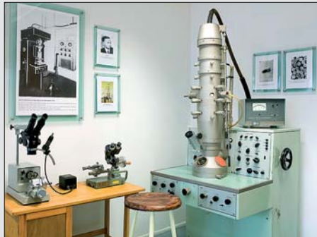
Abbildung 3 Arbeitsplatz für die Elektronenmikroskopie mit einem Elektronenmikroskop des Werkes für Fernsehelektronik Berlin (Baujahr 1966), Auflösungsvermögen etwa ein Nanometer (durch elektronenoptische und lichtoptische Nachvergrößerungen ist eine Gesamtvergrößerung von 1.000.000 : 1 erreichbar) sowie mit zwei Ultramikrotomen mit Präpariermikroskopen (Baujahre 1955 und 1970) zur Herstellung ultradünner Gewebeschnitte für die Elektronenmikroskopie. Schautafeln enthalten einige Informationen zur Geschichte der Elektronenmikroskopie, außerdem wird als Kopie die Nobelpreis-Urkunde für Ernst Ruska aus dem Jahr 1986 für seine Arbeiten zur Entwicklung und den Bau des Elektronenmikroskops gezeigt.
