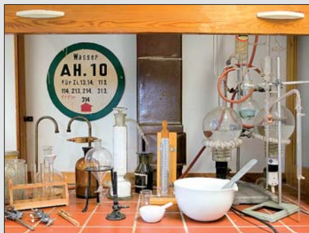
Abbildung 6 Chemischer Arbeitsplatz unter einem Abzug etwa 1950. Verwiesen sei insbesondere auf einen Kipp'schen Apparat zur Herstellung von Gasen (zum Beispiel Wasserstoff, Sauerstoff, Kohlendioxid, Schwefelwasserstoff) auf der Basis chemischer Prozesse, zum Beispiel der Reaktion von Zink mit Salzsäure, wobei gemäß Zn+2HCl=ZnCl_2+H_2 (Zinkchlorid und Wasserstoff) gebildet werden.
