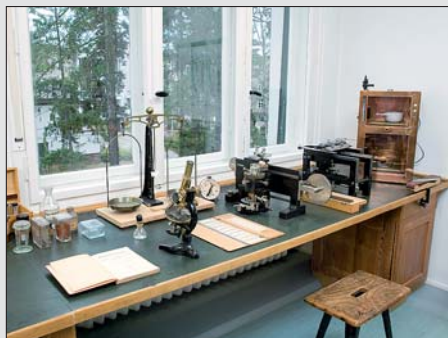
Abbildung 1 Histologischer Arbeitsplatz mit Paraffinschrank für die Einbettung von Organproben in Paraffinblöcke (hinten, rechter Bildteil); Mikrotomen (siehe Abb. 7 und 8) zur Herstellung von Dünnschnitten durch die in Paraffinblöcken eingebetteten Gewebeprobe; Farblösungen (Tinkturen) (Bildmitte links mit Reaktionsgefäßen) zur differenzierten Färbung verschiedener Gewebe- und Zellstrukturen; Mikroskopen (siehe Abb. 9) zur Analyse der histologisch-zytologischen Struktur biologischer Materialien (Zellen/Gewebe).
