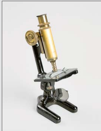
Abbildung 15 Mikroskop der Fa. Paul Waechter (Friedenau-Berlin; Baujahr 1880) mit ausziehbarem Schiebetubus zur Grobeinstellung und Feineinstellung durch Tischneigung per Schraube unter dem Objektivtisch. Gerät mit mehrteiligem Objektiv mit verschiedenen austauschbaren Objektivlinsen und Lochblendscheibe.
