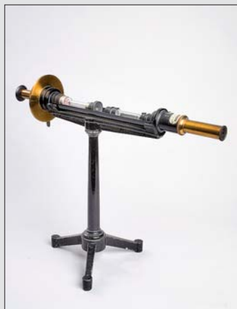
Abbildung 11 Aktinometer nach Michelson der Fa. Mating & Wiesenberg (Potsdam; Baujahr ca. 1950) zur Spektralanalyse von Lichtquellen.
