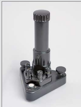
Abbildung 18 Von dem niederländischen Physiologen Willem Einthoven 1903 entwickeltes Galvanometer zur Registrierung geringer, zum Beispiel aus dem Gehirn oder dem Herzen abgeleiteter Aktionsströme. Für seine Arbeiten über den Mechanismus der Elektrokardiographie erhielt Einthoven 1924 den Medizin-Nobelpreis.
