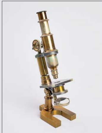
Abbildung 10 Mikroskop der Fa. Eduard Messter (Berlin; Baujahr um 1890) mit ausziehbarem Schiebetubus und Objektiv mit mehreren austausch- und unterschiedlich kombinierbaren Objektivlinsen zur Herstellung verschiedener Vergrößerungen.
