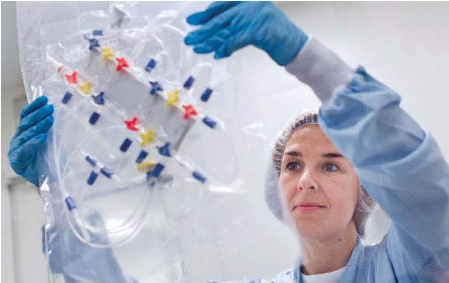
Überprüfung einer Synthesekassette für Modular-Lab
